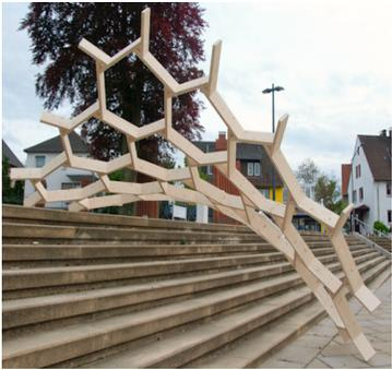
Se pueden realizar redes con una sola tipología de módulos (módulos sencillos cóncavos o convexos, y/o módulos dobles) o también se pueden combinar las diferentes tipologías.
